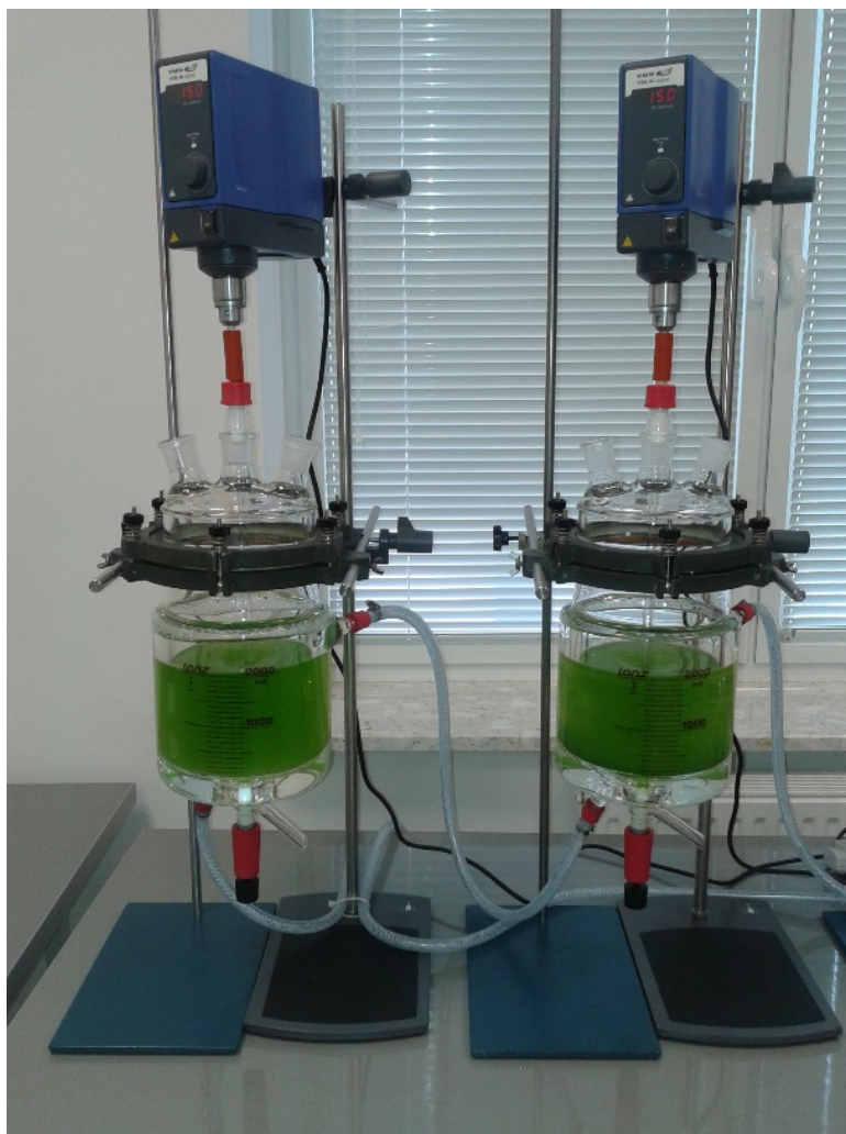
Rys. 10. Stanowisko laboratoryjne do prowadzenia hodowli alg w reaktorach cylindrycznych
