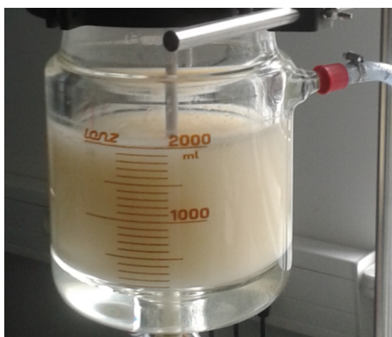
Rys. 81. Stanowisko laboratoryjne do prowadzenia hodowli mikroalg na podłożu z poprodukcyjnych ścieków mleczarskich
