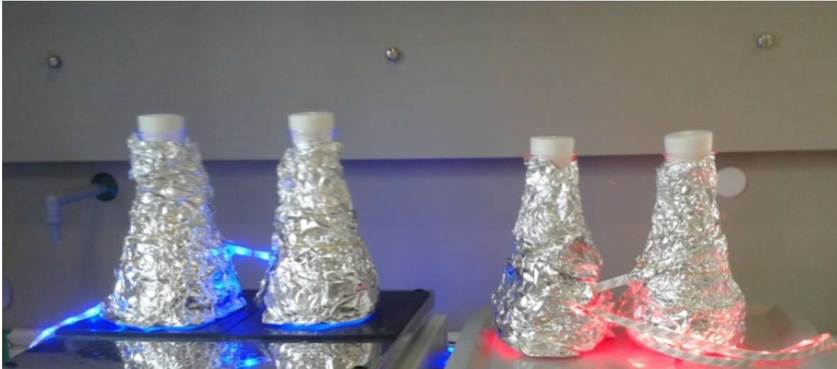
Rys. 12. Stanowisko badawcze do hodowli mikroalg oświetlane różnymi barwami światła
