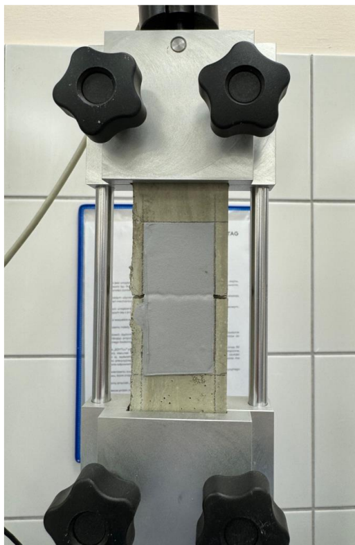
Rys. 16 Próbka zaprawy podczas badania zdolności do mostkowania pęknięć na maszynie wytrzymałościowej [zdjęcie własne]
