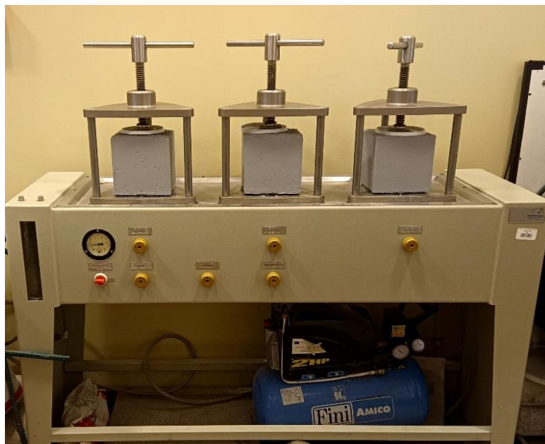
Rys. 11 Urządzenie do badania szczelności betonu wg DIN 1048:1991 [133] oraz wodoszczelności materiałów uszczelniających wg [40] w trakcie badania analizowanych zapraw [zdjęcie własne]
