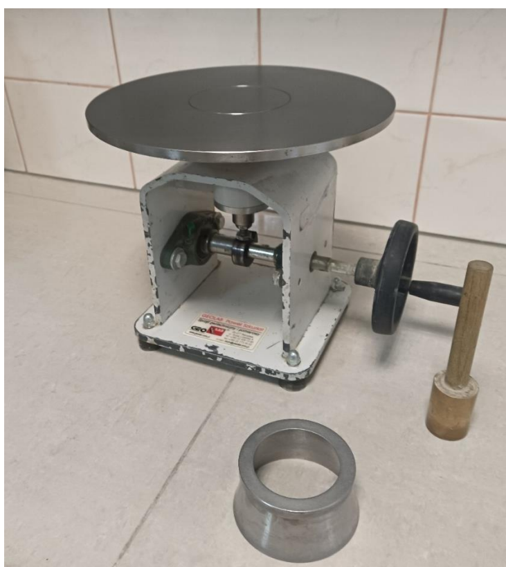
Rys. 7 Stolik rozplýwu używany do badań konsystencji zgodnie z PN-EN 1015-3:2000 [132] [zdjęcie własne]
