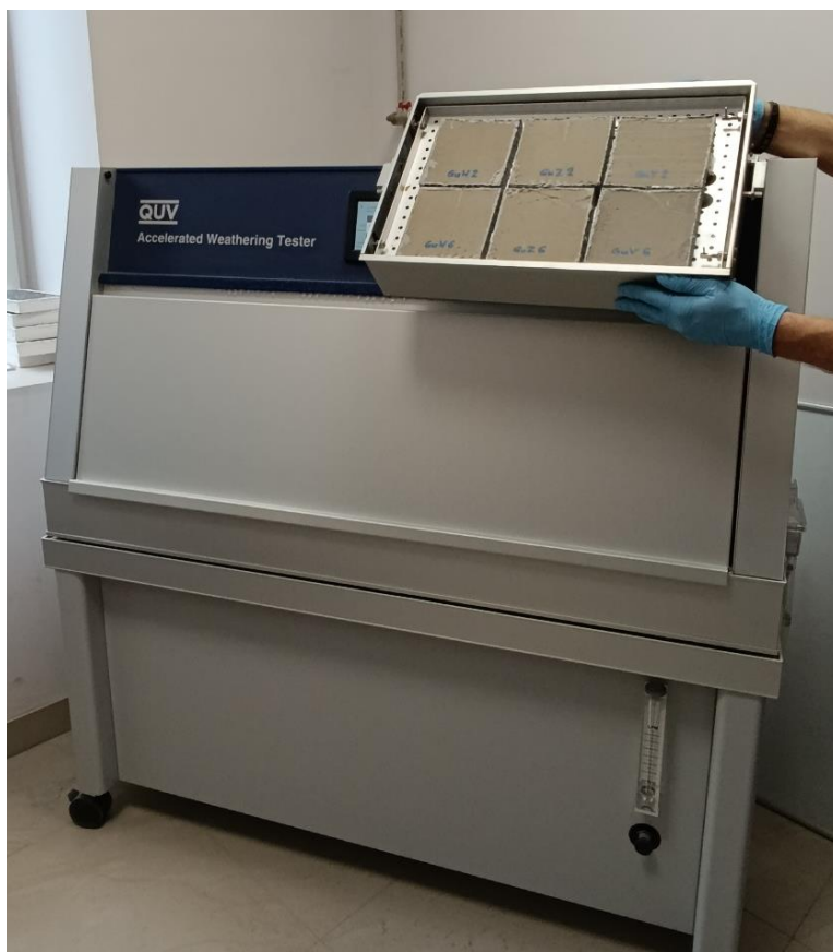
Rys. 17 Komora do przyspieszonych badań starzeniowych Q-Lab QUV, przy użyciu której oceniano trwałość zaprawy poprzez określenie zmiany porowatości powierzchniowej próbek po cyklach starzenia [zdjęcie własne]
