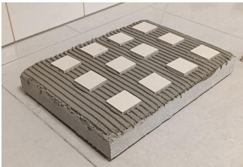
Rys. 12 Próbka zaprawy uszczelniającej przeznaczona do badania przyczepności początkowej zgodnie z PN-EN 14891:2017 [40] [zdjęcie własne]
